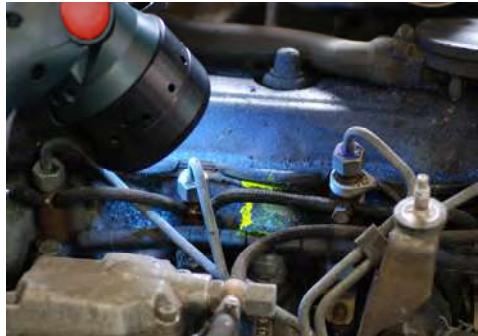
Dichtheitsprüfung am Kraftwagenmotor mit fluoreszierendem Konzentrat H 800
