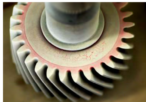
Fehleranzeige sichtbar gemacht mit Farb-Eindringssystem
