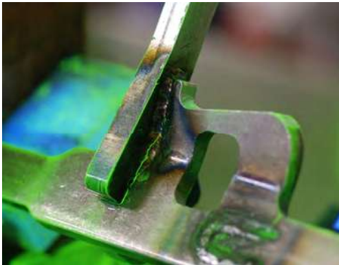
Rissanzeige sichtbar gemacht mit der fluoreszierenden Magnetpulversuspension Super Magna LY 1500 auf Wasserbasis
