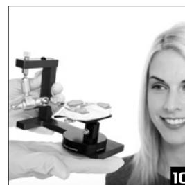
**1 //** Montar previamente o arco facial tanto quanto possível. Deslizar a haste do apoio nasal para trás e apertá-la ligeiramente com o parafuso de bloqueio. Colocar firmemente o suporte articulado com o parafuso de manípulo virado para a direita no arco facial e apertá-lo também ligeiramente. Soltar os parafusos de bloqueio do arco facial e abrir o arco, afastando as extremidades.
